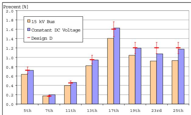
Fig. 24. Spectrum of 5<sup>th</sup> 7<sup>th</sup> 11<sup>th</sup> 13<sup>th</sup> 17<sup>th</sup> 19<sup>th</sup> 23<sup>rd</sup> 25<sup>th</sup> harmonics content of the output voltage waveform with constant dc voltage.
